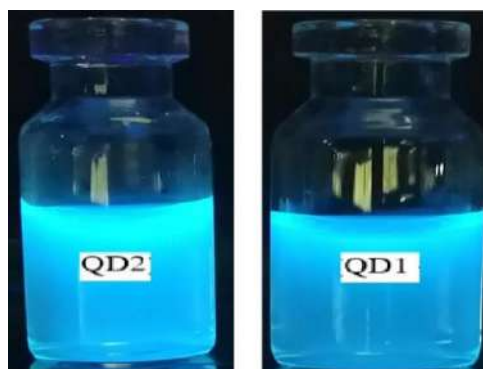
شکل (۳-۱۷) حسگرهای سنتز شده زیر لامپ UV با نشر ۳۶۵ نانومتر
